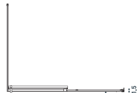
Il profilo a muro è arretrato rispetto al supporto barra superiore Wall profile is set back from upper bar footprint
