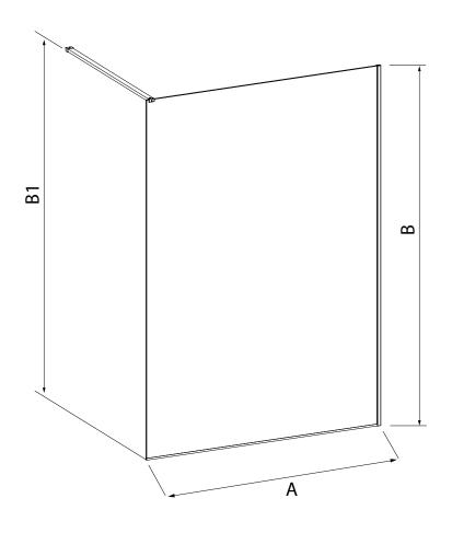
Cristallo temperato di sicurezza 8mm Componenti e profili in acciaio inox Produzione su misura Regolazione fuori piombo ± 0,5 cm Finitura profilo acciaio spazzolato o lucido
